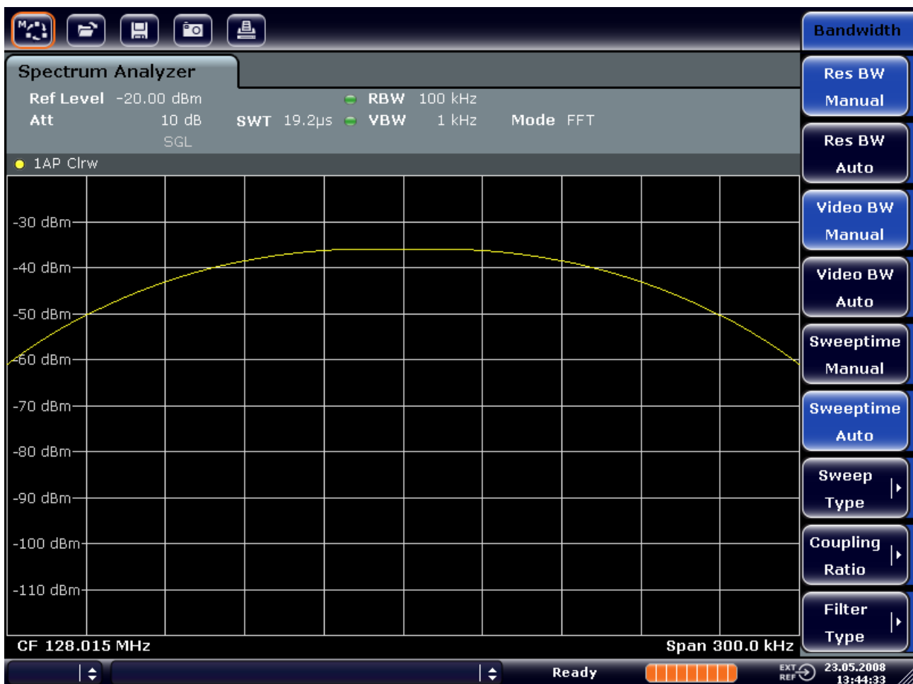
Figure 5-5: Mesure de deux signaux RF sinusoïdaux de même niveau avec une largeur de bande de résolution supérieure à leur écart de fréquence.
